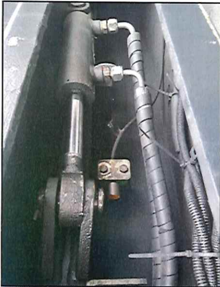
Local: Spreader Item # 22: pequeno vazamento em ambos cilindros de tracamento dos twist-locks . Status: corrigido .
