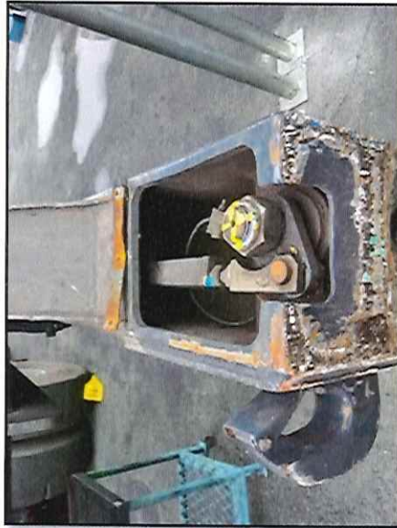
Local: Spreader Item # 27: falta uma das borrachas de proteção dos sensores de aterrizagem do spreader. Status: corrigido .
